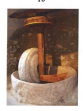
Pour maintenir la verticalité du mât, ce dernier est solidaire, dans sa partie haute, d'une poutre surplombant le moulin (11). Ainsi, animé d'un double mouvement, le broyeur tourne sur lui-même tout en pivotant autour du mât. La meule gisante est légèrement concave et dispose d'un rebord en périphérie pour éviter de disperser le broyat (12).
